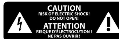
I terminali contrassegnati da questo simbolo conducono una corrente elettrica di magnitudine sufficiente a costituire un rischio di scossa elettrica. Utilizzare solo cavi per altoparlanti professionali di alta qualità con jack sbilanciati da 6,35mm. o connettori con blocco a rotazione. Tutte le altre installazioni o modifiche devono essere eseguite esclusivamente da personale qualificato.
