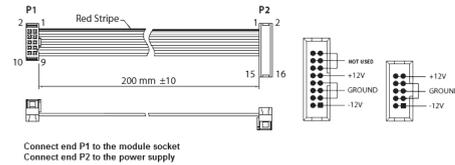
De unit wordt geleverd met de benodigde voedingskabel voor aansluiting op een standaard Eurorack-voedingssysteem. Volg deze stappen om de module van stroom te voorzien. Het is gemakkelijker om deze aansluitingen te maken voordat de module in een rekbehuizing is gemonteerd.
