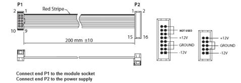
La unidad viene con el cable de alimentación necesario para conectarse a un sistema de alimentación estándar Eurorack. Siga estos pasos para conectar la alimentación al módulo. Es más fácil realizar estas conexiones antes de que el módulo se haya montado en una caja de rack.
