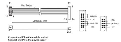
L'unità viene fornita con il cavo di alimentazione necessario per il collegamento a un sistema di alimentazione Eurorack standard. Seguire questi passaggi per collegare l'alimentazione al modulo. È più facile effettuare questi collegamenti prima che il modulo sia stato montato in un case rack.
