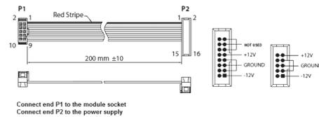
A unidade vem com o cabo de alimentação necessário para conectar a um sistema de fonte de alimentação Eurorack padrão. Siga estas etapas para conectar a alimentação ao módulo. É mais fácil fazer essas conexões antes que o módulo seja montado em um gabinete de rack.
