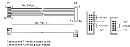
Do modułu dołączony jest wymagany kabel zasilający do podłączenia do standardowego systemu zasilania Eurorack. Wykonaj poniższe czynności, aby podłączyć zasilanie do modułu. Łatwiej jest wykonać te połączenia przed zamontowaniem modułu w obudowie rack.
