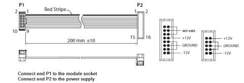
Enheten levereras med den strömkabel som krävs för att ansluta till ett vanligt Eurorack-nättaggregat. Följ dessa steg för att ansluta ström till modulen. Det är lättare att göra dessa anslutningar innan modulen har monterats i ett rackfodral.
